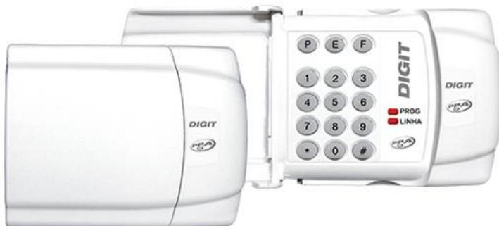
O tele alarme funciona através de uma linha telefônica. Faz ligações para os números registrados quando a temperatura está fora da faixa programada, se a tensão da bateria estiver baixa, sobre funcionamento da rede elétrica e porta aberta. Para que o discador funcione, é necessário conectar um cabo telefônico.
