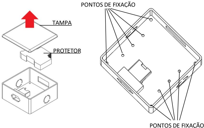
Para fixação da caixa do Kit DPS, basta posicionará-la ao local desejado e inserir os parafusos através dos pontos de fixação.
