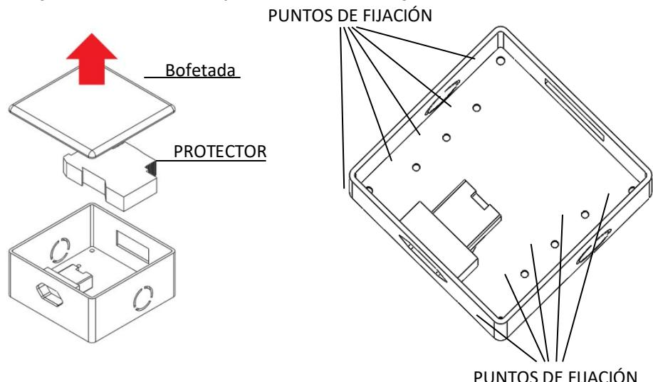
Para asegurar la carcasa del kit DPS, simplemente colóquela en la ubicación deseada e inserte los tornillos a través de los puntos de fijación.
