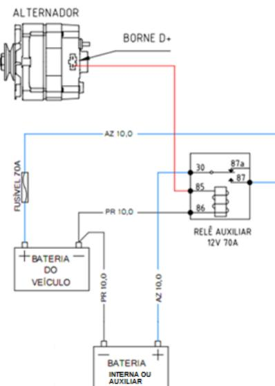
Para la instalación de la conservadora, utilizar un conductor eléctrico exclusivo de la batería para conectar la nevera. Dimensionar el conductor eléctrico (cable) de acuerdo con la distancia entre la conservadora y la batería según el cuadro siguiente:
