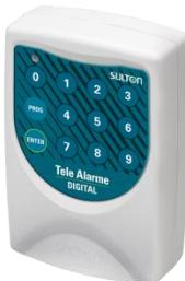
El tele-alarma funciona a través de una línea telefónica. Hace conexiones a los números registrados cuando la temperatura sale de la pista programada, o si la tensión de la batería es baja. Para que el marcador funcione, es necesario conectar un cable telefónico.
