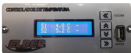
O primeiro sensor representará a temperatura no interior da conservadora. Quando possui dois sensores, o segundo sensor representará a temperatura no interior do tubo de glicerol, que simula a temperatura do material armazenado.
