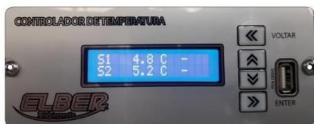
El primer sensor representará la temperatura dentro del conservador. Cuando tiene dos sensores, el segundo sensor representará la temperatura dentro del tubo de glicerol, que simula la temperatura del material almacenado.
