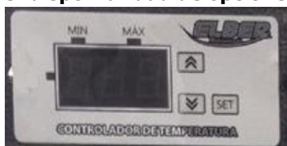
El controlador V2.7 registra continuamente la temperatura más baja y más alta alcanzada por el sensor. Para verificar las temperaturas registradas, presione la tecla para la temperatura máxima y para la temperatura mínima. La pantalla mostrará la temperatura durante unos segundos y luego volverá al funcionamiento normal.
