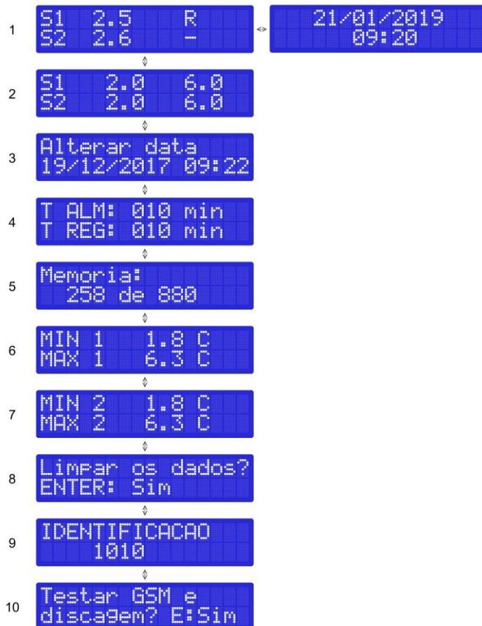
O menu 1 alterna entre as temperaturas dos sensores e a data/hora a cada 2 ou 3 segundos. A letra "R" indica que o compressor está ligado.
